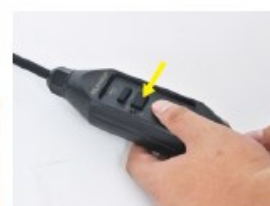
4. לחץ על RESET נורת המחוון תהפוך אדומה. ה-RCD תקין.
